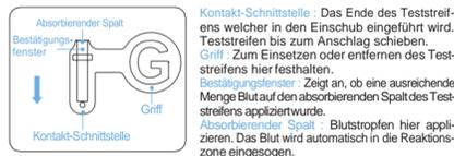
**Kontakt-Schnittstelle** : Das Ende des Teststreifens welcher in den Einschub eingeführt wird. Teststreifen bis zum Anschlag schieben.
